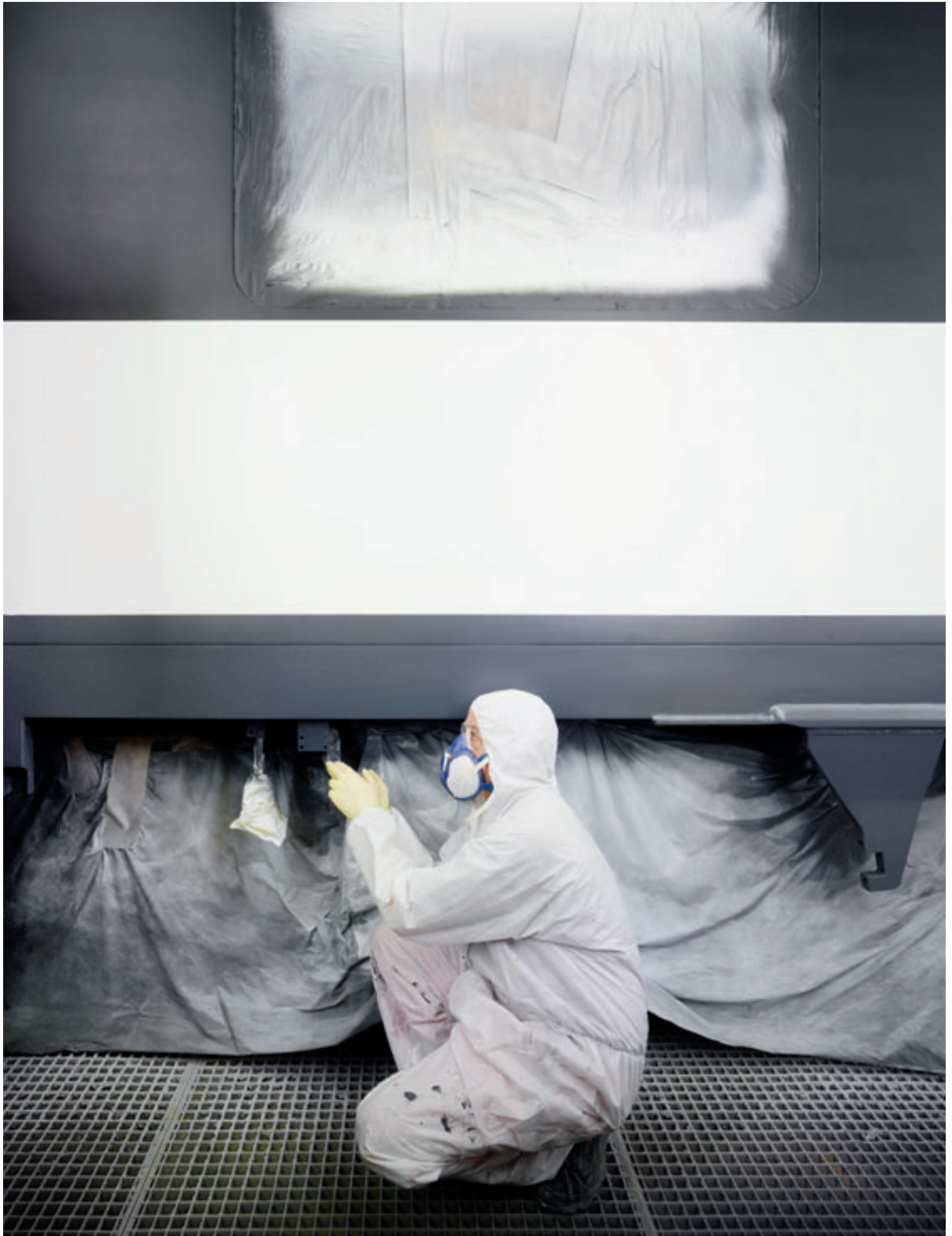
Im Industriewerk Olten werden Werterhaltsarbeiten für die bestehende Fahrzeugflotte ausgeführt. Im Bild ein Mitarbeiter bei Abdeckerarbeiten in der Lackierkabine, daneben ein frisch lackierter Fernverkehrswagen des Typs EW IV.
