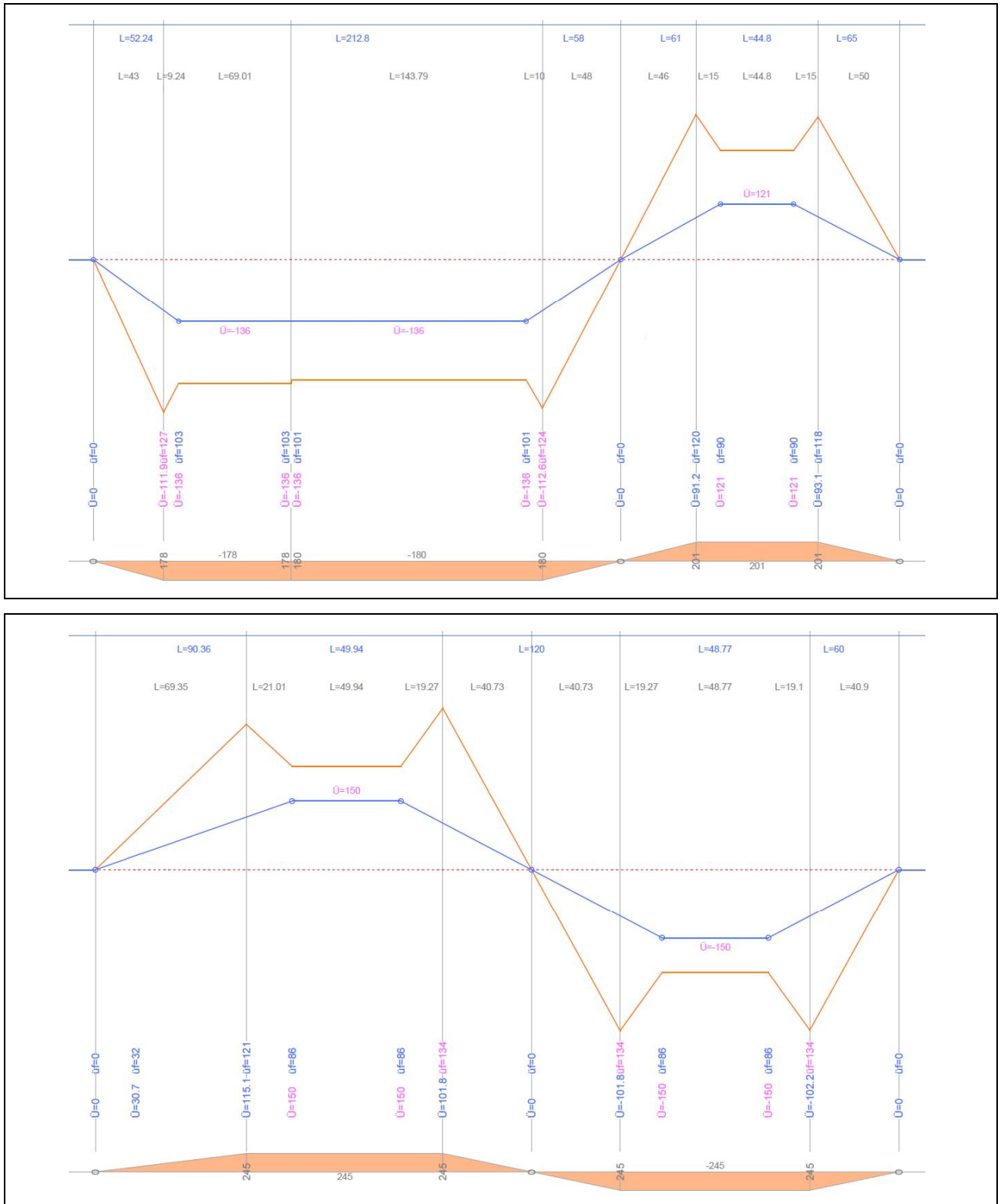
Abb. 2-6 und 2-7: Reale Trassierungsbeispiele mit \bar{u} -Spitzen, sogenannte „Katzenoehren“ (Quelle: SBB I-AT-FW-TNZ)
