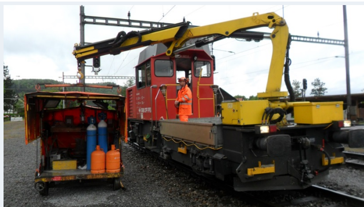
Abbildung 1: Beladung von einem Tm 234 0xx (1. Serie) mit einem Schweissanhänger
