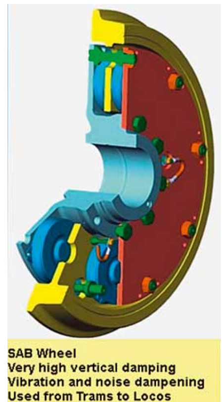
I Bild 4: Schubbeanspruchtes gummigefedertes Rad [15]
