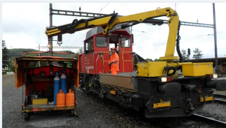
Figure 1: chargement d'un véhicule Tm 234 0xx (1<sup>re</sup> série) avec une remorque de soudage
