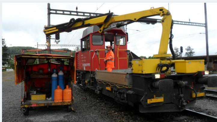
Figure 2: chargement d'un véhicule Tm 234 0xx (1<sup>re</sup> série) avec une remorque de soudage
