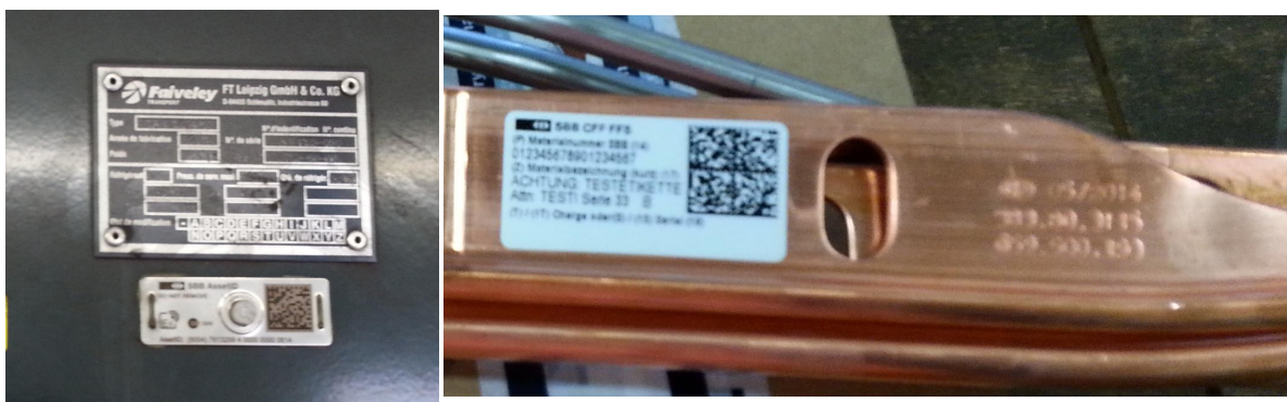
Abbildung 3: Beispiele für Typenschilder
