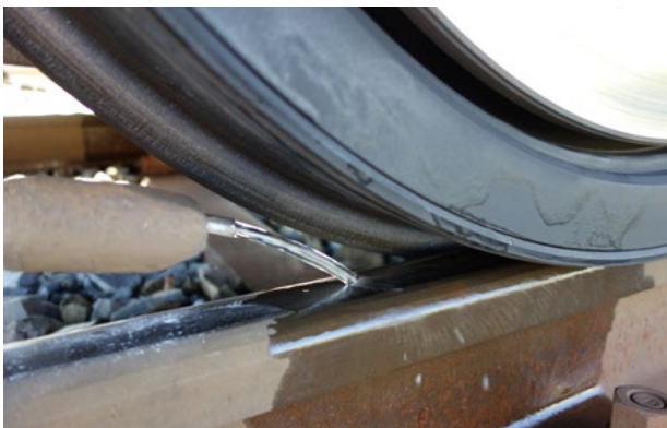
Haftwertbeeinflussung mittels Seifenwasser-Dosiereinrichtung
