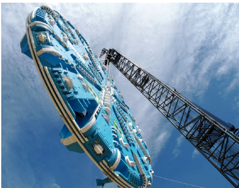
Der Bohrkopf einer Tunnelbohrmaschine: Mit ihm wird mechanisch und daher schonender ausgebrochen, als beim konventionellen Vorgehen mit Sprengungen.
